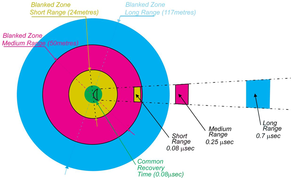
*Figure 2.1 - Radar blanking zones.*
